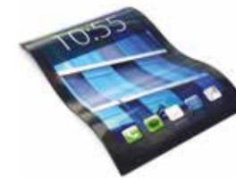
**Telas plásticas flexíveis**, diodos orgânicos emissores de luz são colocados em uma folha plástica criando aparelhos eletrônicos com displays flexíveis.
